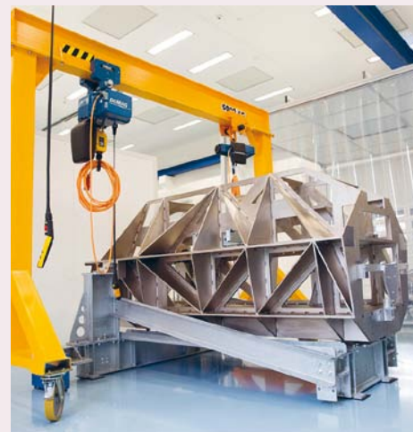
Squelette du spectrographe ESPRESSO
