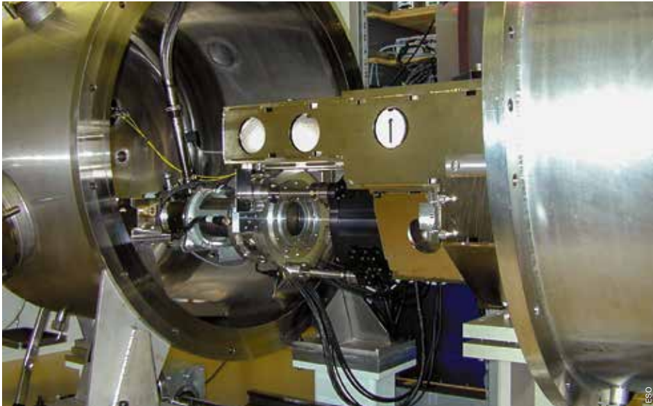
Le spectrographe Harps à l'intérieur de sa cuve à vide, ouverte pour les besoins de tests en laboratoire. Cet instrument est actuellement installé sur le télescope de 3,6 mètres de diamètre de l'ESO à La Silla au Chili.
