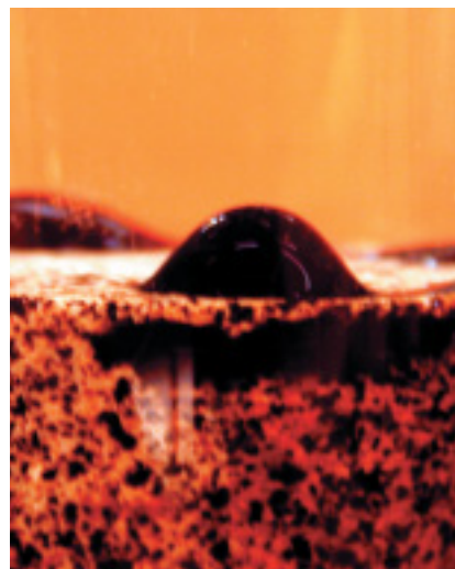
L'huile est extraite d'un milieu poreux carbonaté en la remplaçant par de l'eau.
