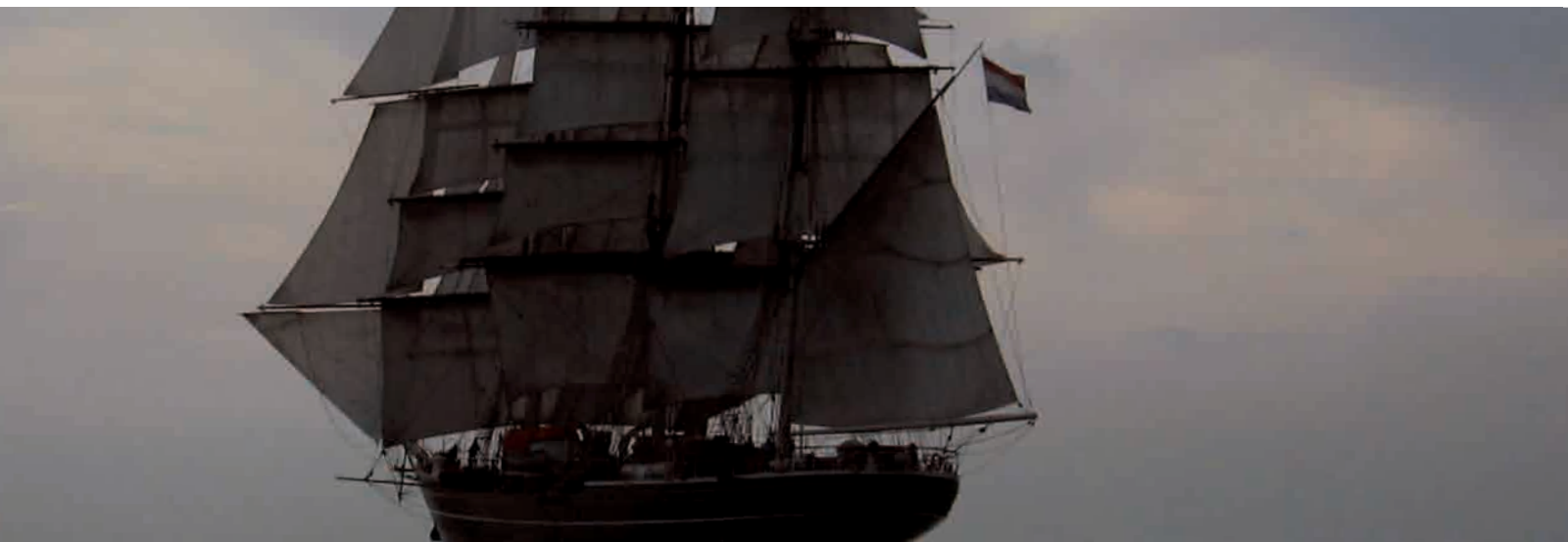
Le «Stad Amsterdam» est un trois-mâts de 76 mètres de long. Il a été construit en 2000 sur le modèle des clipper du XIX e siècle, mais en intégrant la technologie moderne.
