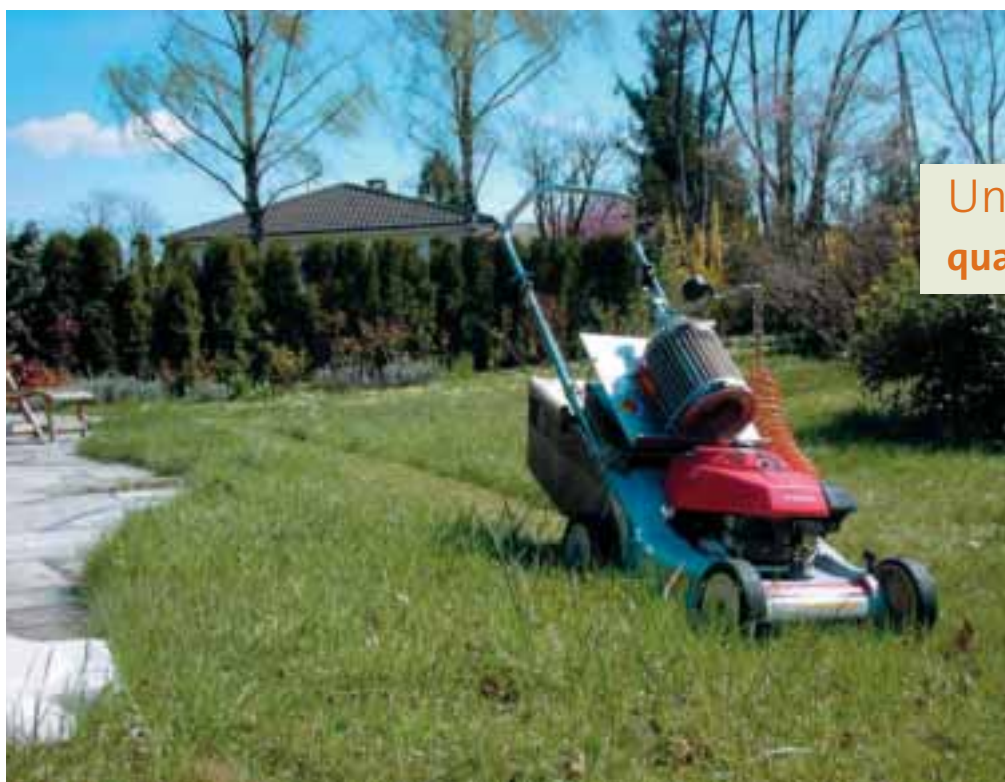
La tondeuse à gazon de Klaus Yvon, professeur de cristallographie, est munie d'un réservoir à hydrogène.
