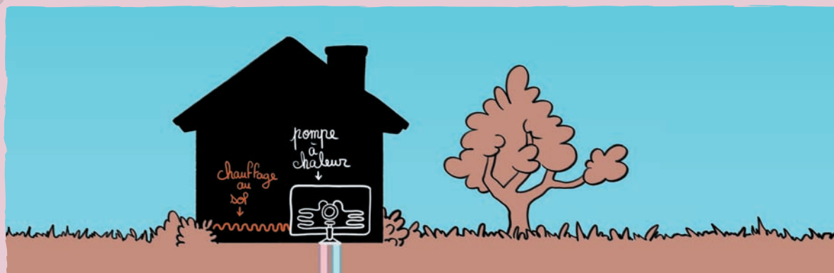
Cette eau n'est pas encore assez chaude. Elle doit passer par une pompe à chaleur électrique qui la chauffe encore de quelques dizaines de degrés avant de transférer sa chaleur aux radiateurs ou au chauffage au sol.
