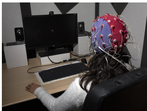
Participant munie de l'EEG permettant de mesurer l'activité électrique du cerveau.
