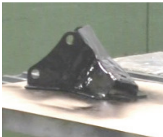
Fig. 1: La pièce métallique de châssis de voiture en fin de réparation
