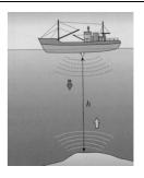
Un sonar (ci-dessus) émet des salves très brèves d'ultrasons qui parcourent l'eau à vitesse constante  $v_s$  ( $v_s = 1,5 \times 10^3 \text{ m.s}^{-1}$ ). La durée t séparant l'émission de la réception d'une salve après sa réflexion sur le fond est proportionnelle à la distance 2.h parcourue par les ultrasons. L'appareil en déduit la profondeur h de l'eau :  $h = v_s \cdot t / 2$
