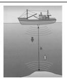
Un sonar (ci-contre) émet des salves très brèves d'ultrasons qui parcourent l'eau à vitesse constante  $v_s$  ( $v_s = 1,5 \times 10^3 \text{ m.s}^{-1}$ ). La durée t séparant l'émission de la réception d'une salve après sa réflexion sur le fond est proportionnelle à la distance 2.h parcourue par les ultrasons. L'appareil en déduit la profondeur h de l'eau :  $h = v_s \cdot t / 2$
