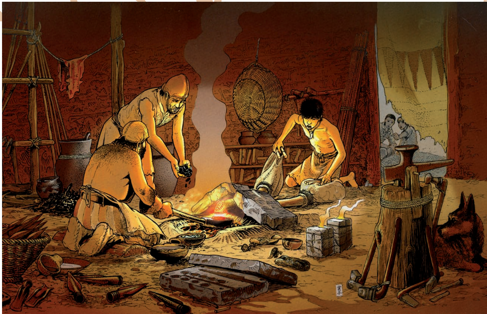
Fig. 1 : Reconstitution d'un atelier de bronziers du 10 e -9 e s. av. J.-C. L'atelier est aménagé sur un sol en terre battue. Le foyer, qui est creusé dans le sol, est attisé par deux soufflets. Le métal fondu est coulé dans des moules en pierre comme celui représenté au premier plan. Image tirée de Gally 2006, dessin d'André Houot
