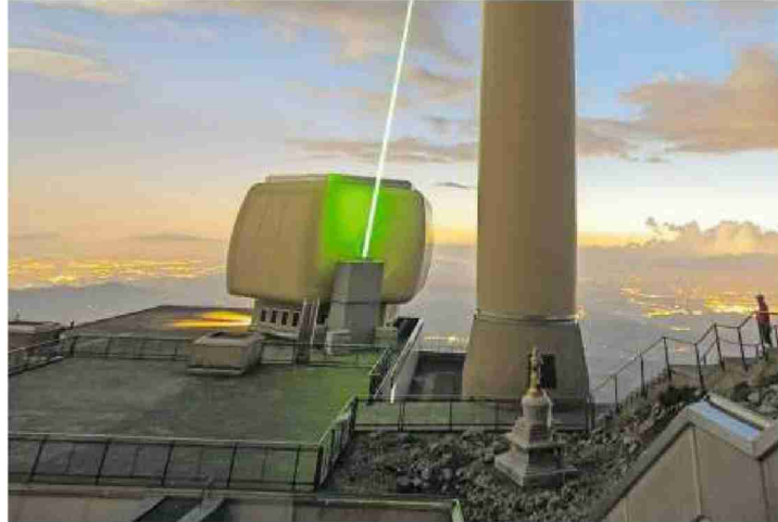
Ein Ultrakurzpuls laser ionisiert die Luft und leitet so den Blitz.
