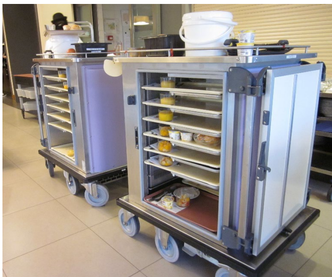
Figure 11 : Chariot thermique utilisé pour servir des repas dans les chambres des résidentes
