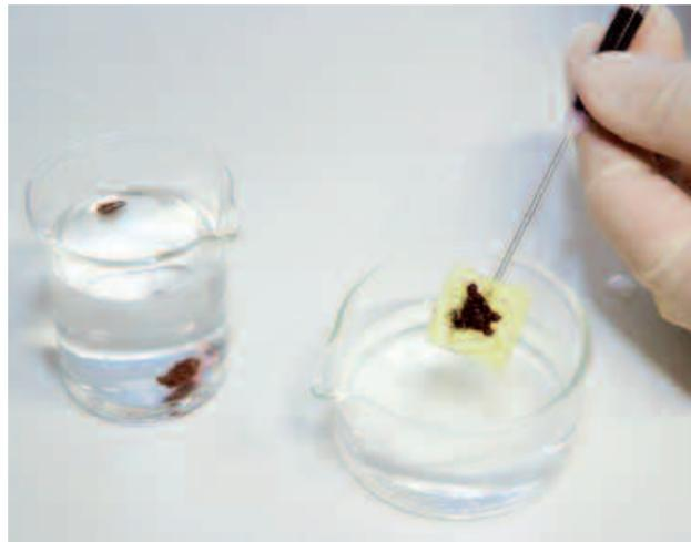
Injection d'un implant (brun) dans les cavités poreuses d'un matériau modélisant l'os.
