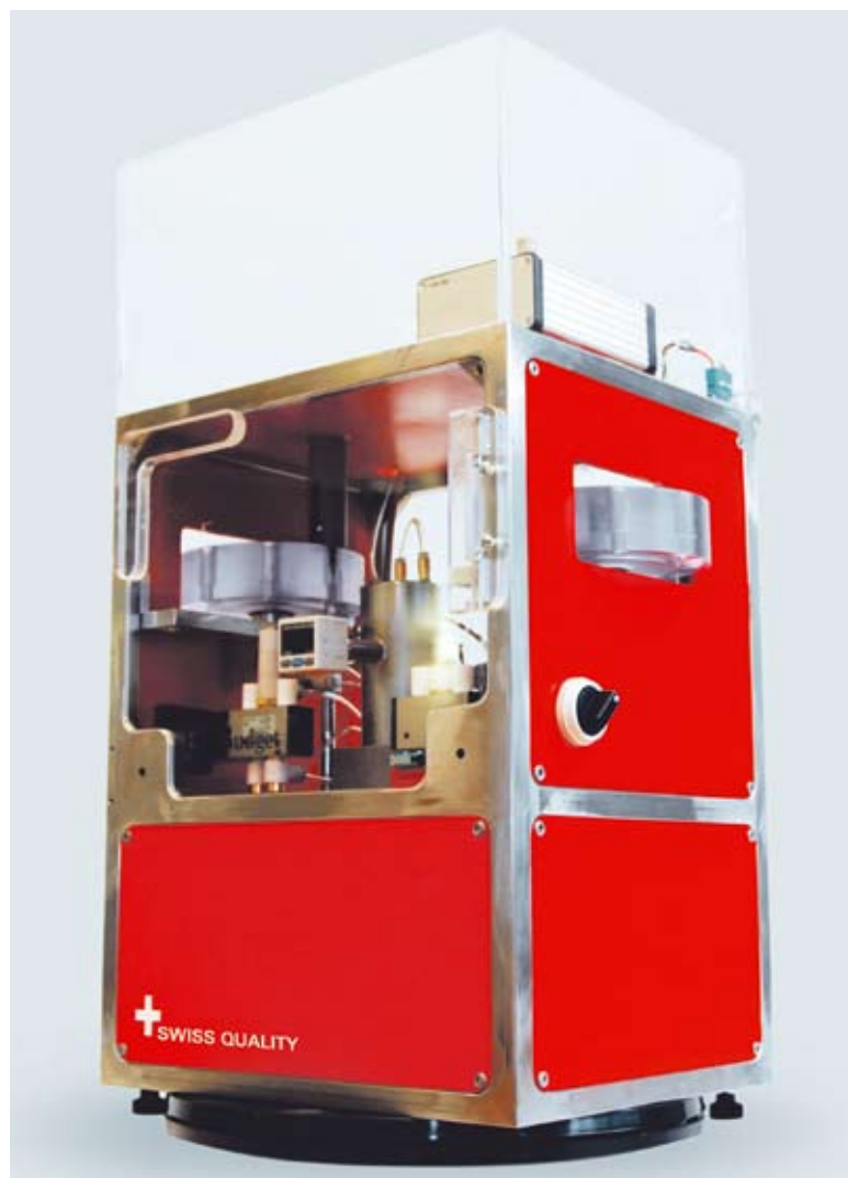
Détecteur de contrefaçons de médicaments mis au point à l'Ecole de pharmacie Genève-Lausanne, avec la collaboration de l'Ecole d'ingénieurs et d'architectes de Fribourg. Photo: DR
